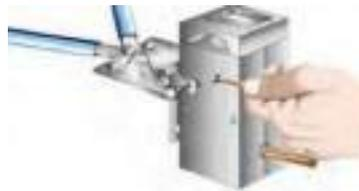
4. Feche a tampa do molde, acenda o palito ignitor (IGNEX), e rapidamente atire-o sobre o pó, pela abertura da tampa, dando início a reação exotérmica, que realizará a soldagem. Após alguns segundos, abra o molde e REMOVA a escória. O molde está pronto para uma NOVA conexão.
