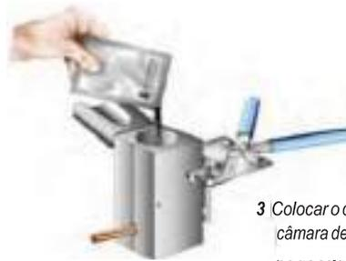
3 Colocar o disco metálico no fundo da câmara de reação, depois despeje o pó exotérmico, sem comprimi-lo.
