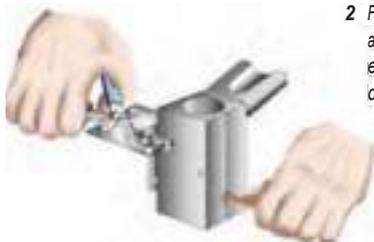
2 Feche o molde, VERIFICANDO se as extremidades dos cabos e tão centralizadas na câmara de soldagem.
