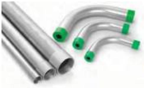
Eletrodutos zincados eletrolíticos são produzidos em aço carbono, com costura e fornecidos em barras com 3 metros nas bitolas de 1/2" a 4", possuem rosca paralela em ambas as extremidades, com LUVVA em uma delas e protetor de plástico em outra.
