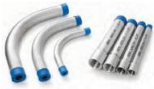
Em alumínio Schedule 40, nas bitolas entre 1/2" a 6", barras com 3 metros, rosca BSP ou NPT, LUVVA e protetor de rosca. Utilizados em ambientes com umidade, VAPORES, e locais sujeitos a ELEVADO teor de corrosão, como: sistemas de esgoto, estações de tratamento de água, fábricas de filtros, instalações de água salgada, indústrias químicas e petroquímicas, além de instalações que não exijam pintura de manutenção e/ou tratamento protetor.
